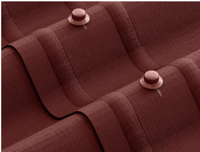
Ондулин SMART оснащен специальным гидрозамком Smart Lock из двух полос, выдавленных по краям листа. Направляющие бороздки регулируют торцевой нахлест и образуют герметичные стыки. Заводская разметка точек крепления облегчает монтаж.
